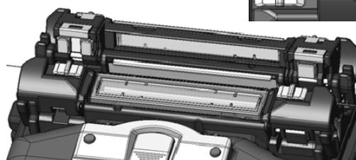
如果加热器盖和加热器夹具分离，单独活动后、可以手动调整保护套管的位置。
