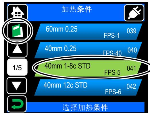
在加热条件选择画面中(参考 4-2 页), 选定希望变更的加热条件, 点击设定图标 ( )。出现项目选定画面。
