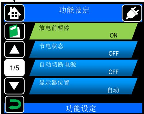
点击希望设定的项目, 图标变色后, 再点击一次确认, 出现设定变更画面。
