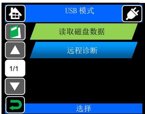
点击菜单画面的 USB 图标后 (
