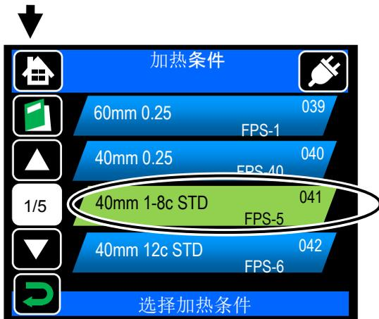
点击选定加热补强条件后，图标变色，再次点击确定。
