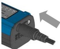
1. 将附带的直流电源线（型号：PC-B[C]）连接到 JR-7 的对应插孔内。
