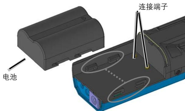
将电池底部接合凹槽部对准图示椭圆内的本体侧卡爪部位后向右滑动电池至安装到位。
